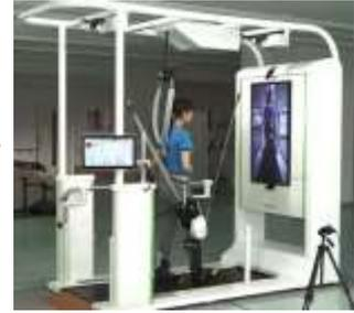
ウェルウォークはトレッドミルやモニターを含むシステム全体を訓練用ロボットシステムとして構成した本体と、麻痺側の脚に装着し、膝の曲げ伸ばし動作を助けるロボット脚本体から構成されます。
